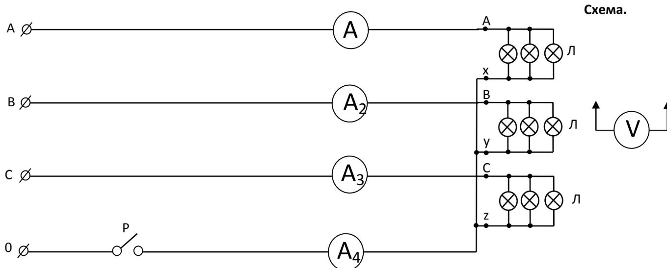
2. После проверки схемы преподавателем включить трёхполюсный рубильник, установить равномерную нагрузку фаз. При выключенном однополюсном рубильнике измерить фазные и линейные напряжения и токи. Показания приборов записать в таблицу (опыт №1).
